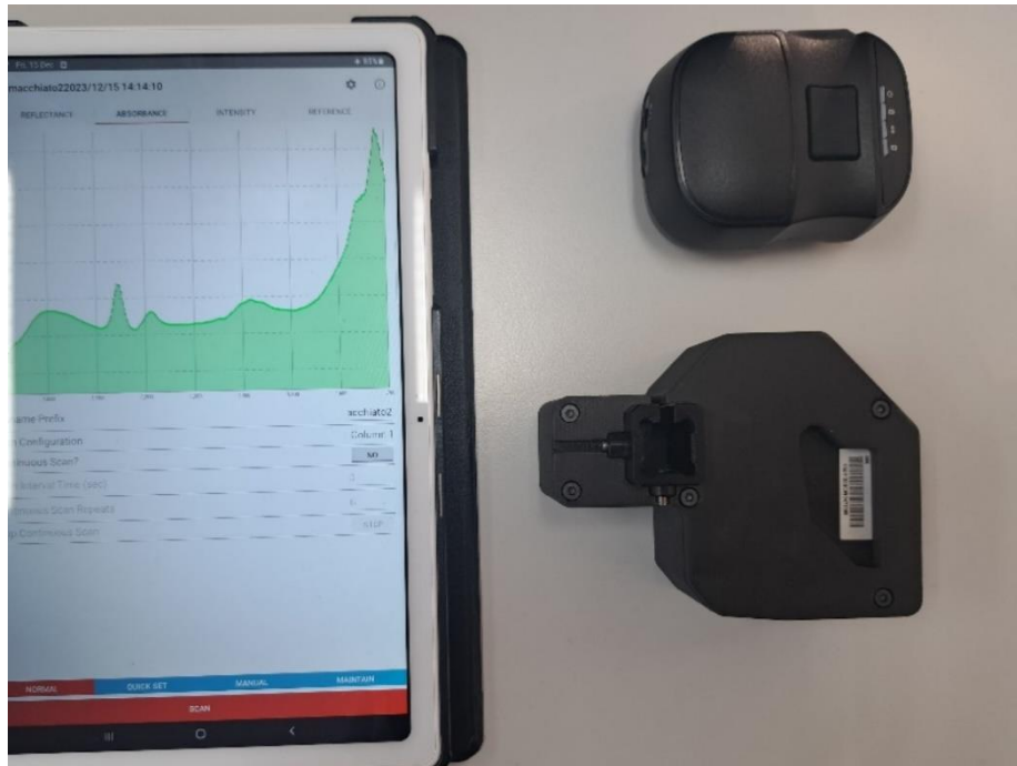
Slika 5. Prijenosni NIR instrument s nastavkom za tekuće i praškaste uzorke (vlastita fotografija)
