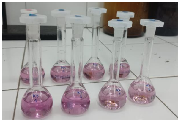
Slika 7. Uzorci pripremljeni za mjerenje apsorbancije pri valnoj duljini od 525 nm (vlastita fotografija)
