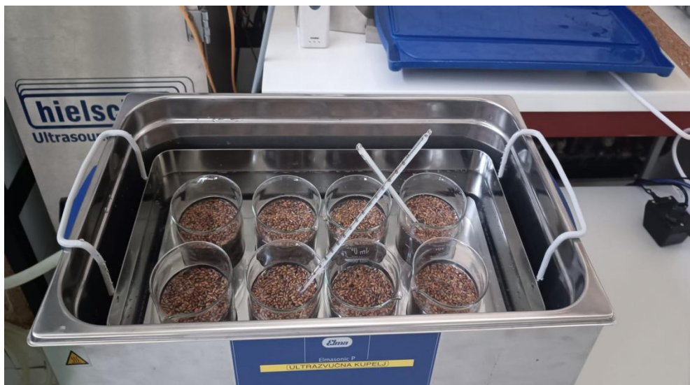
Slika 5. Predtretman sjemenki grožđa ultrazvukom primjenom ultrazvučne kupelji (vlastita fotografija)
