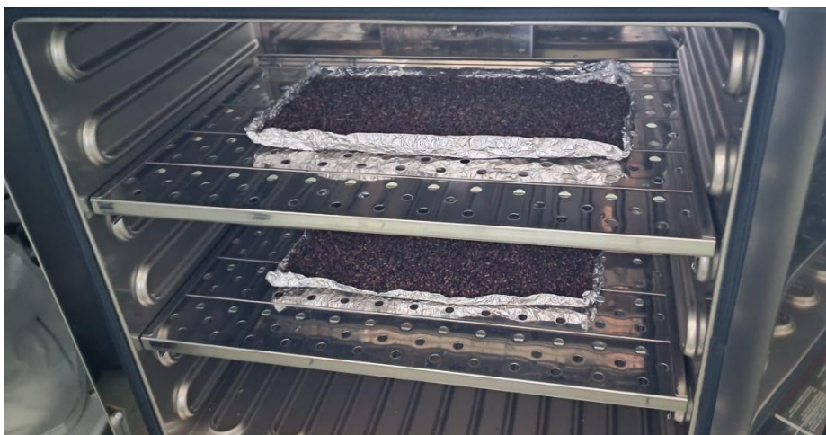
Slika 6. Sušenje uzoraka u laboratorijskoj sušnici (vlastita fotografija)
