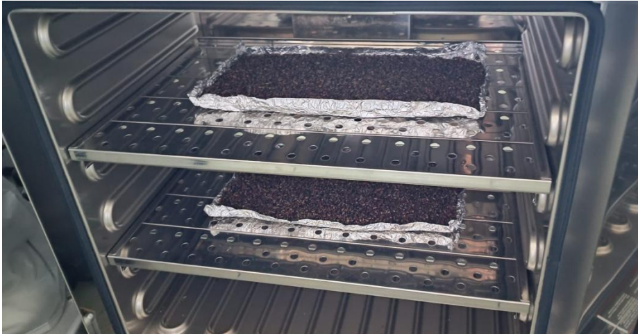
Slika 6. Sušenje uzoraka u laboratorijskoj sušnici (vlastita fotografija)
