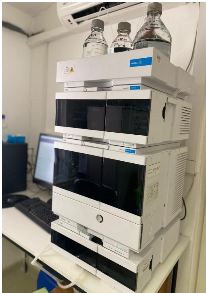
Slika 8. Agilent Technologies 1290 Infinity UPLC uređaj (vlastita fotografija)
