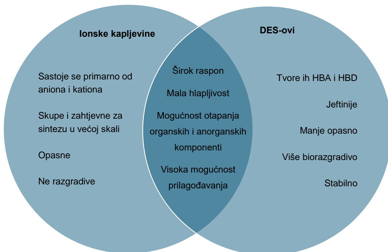
Slika 2. Usporedba ionskih kapljevine i niskotemperaturnih eutektičkih otapala (prema Płotka-Wasyłka i sur., 2020)
