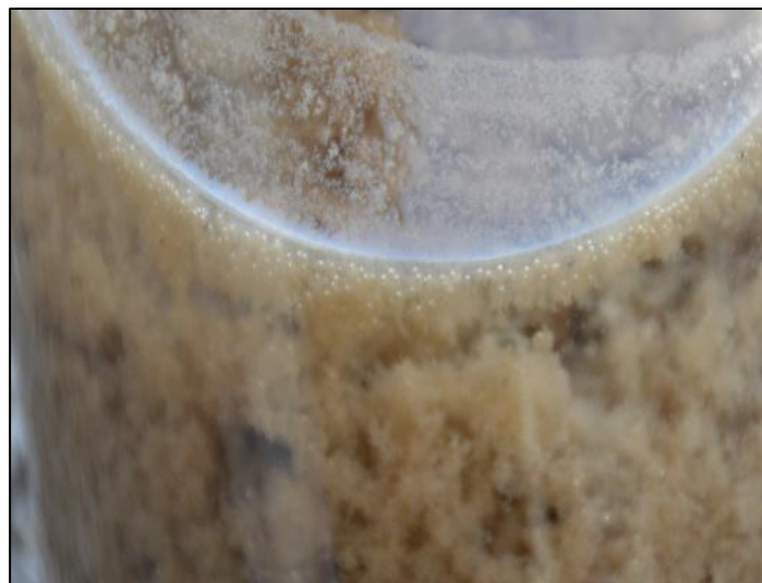
Slika 8. Izgled flokula aktivnog mulja iz bioeracijskog bazena lokalnog uređaja za biološku obradu otpadnih voda grada
