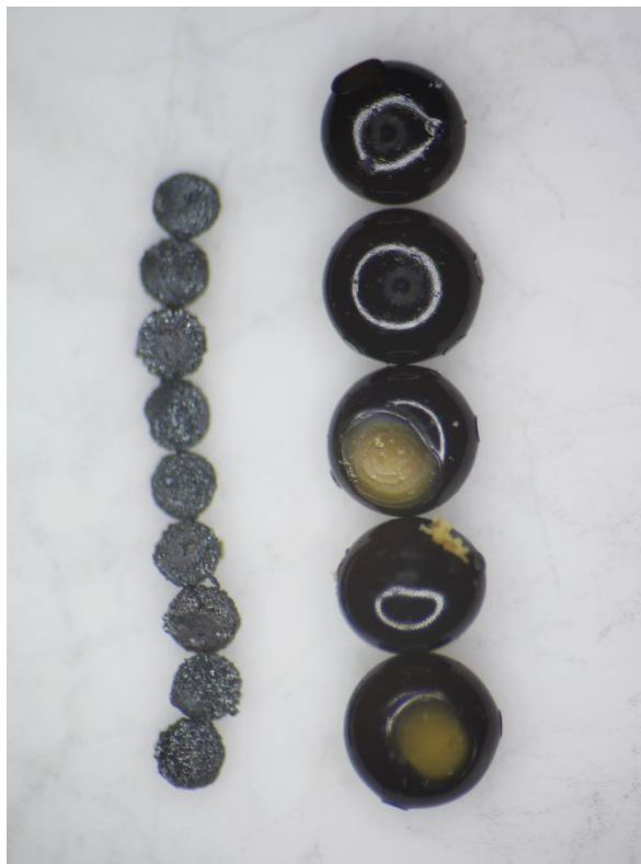
Slika 16. Optička mikrografija čestica alginatnog gela umreženog ionima \text{Fe}^{3+} prije pirolize (desno) te nakon pirolize (lijevo).
