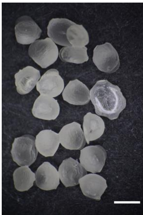
Slika 8. Optička mikrografija čestica alginatnog gela dobivenog umrežavanjem vodene otopine natrijeva alginata, w(\text{Na-alginat}) = 1,0 \% , ionima \text{Ca}^{2+} . Oznaka na slici odgovara duljini od 1 mm.
