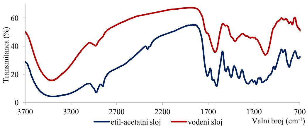
Slika 15. IR-spektrar spojeva izoliranih nakon ekstrakcije tekuće-tekuće
