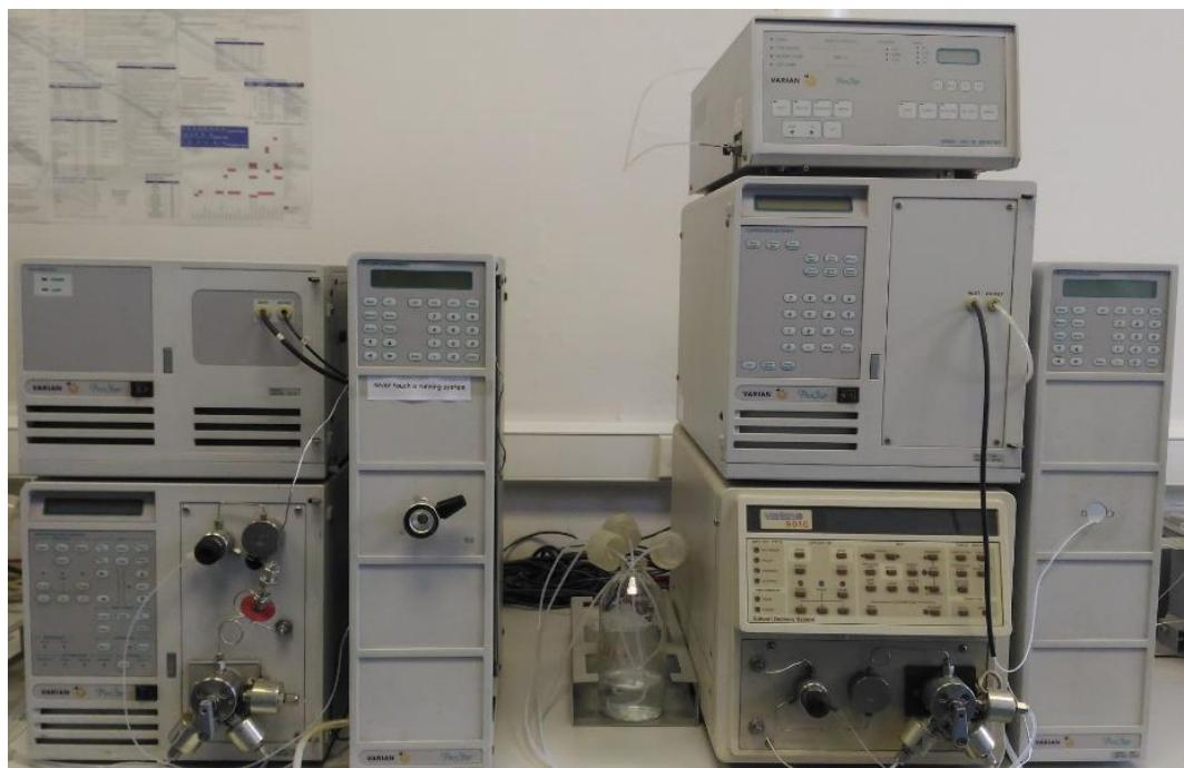
Slika 4. HPLC sustav s PDA detektorom (vlastita)
