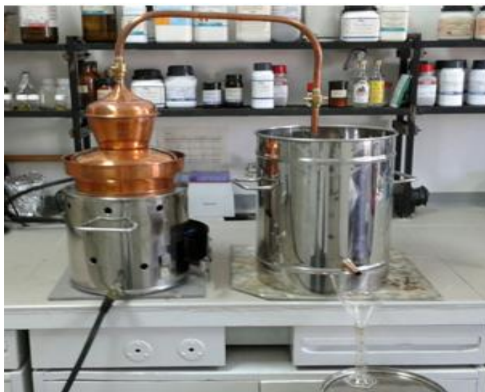
Slika 6. Laboratorijski šaržni kotao za destilaciju (vlastita fotografija).
