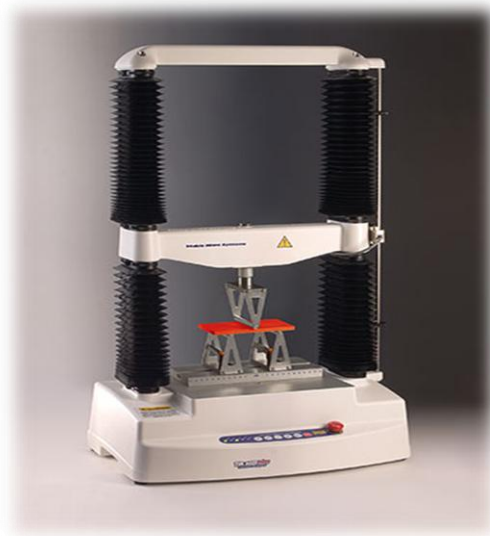
Slika 5. Analizator teksture TA.HDPlus (Stable Micro Systems, Velika Britanija)
