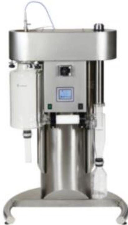
**Slika 7.** Sušionik za sušenje raspršivanjem SD 06
