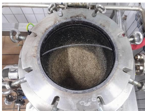
Slika 6. Usitnjena kukuruzovina u visokotlačnom reaktoru za predobradu lignoceluloznih sirovina.
