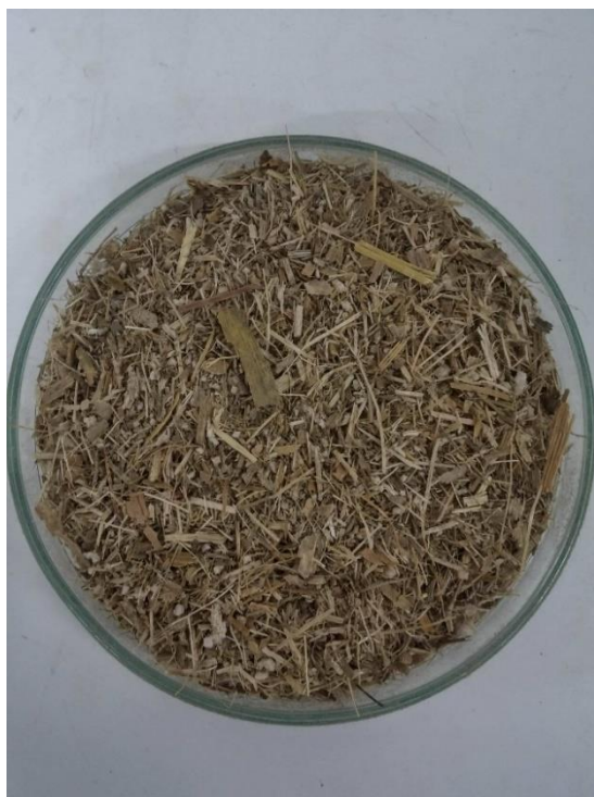
Slika 3. Kukuruzovina usitnjena na mlinu čekičaru.
