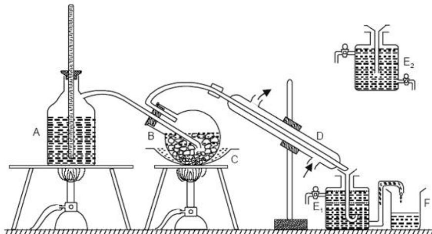
**Slika 6.** Direktna destilacija parom (A- generator pare; B- tirkvica za destilaciju; C- pješčana kupelj; D- Liebigovo hladilo; E<sub>1</sub>- spremnik za ulja lakša od vode; E<sub>2</sub>- spremnik za ulja teža od vode; F- čaša) (Anonymous 5).
