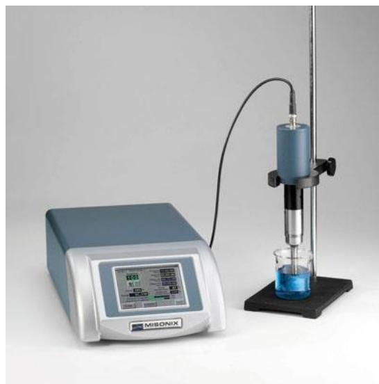
**Slika 3.** Uredaj za ekstrakciju potpomognutu ultrazvukom proizvođača Misonix (model Sonicator S-4000) (Anonymus 2, 2017)
