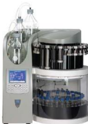
Slika 4. Sustav za ubrzanu ekstrakciju otapalima pri povišenom tlaku (Dionex ASE 350) (Yang i sur., 2014)
