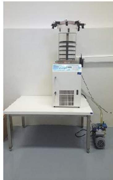
Slika 7. Shematski prikaz laboratorijskog liofilizatora.
