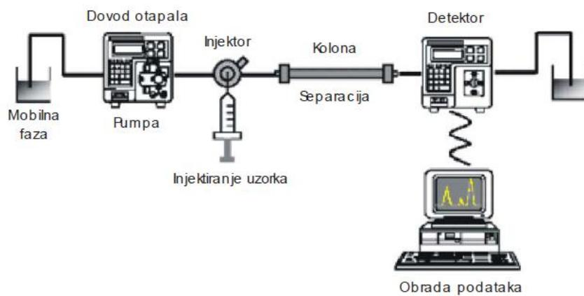
**Slika 1.** Shematski prikaz HPLC sustava (Nesek, 2004)
