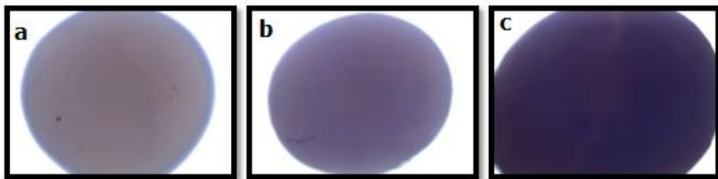
Slika 6. Mikroskopska slika hidrogel čestica s inkapsuliranim ekstraktom ružmarina pripremljenih s 5%-tnim alginatom (a-c): a-alginat (čisti); b-alginat i izolati proteina sirutke; c-alginat i zelena kava
