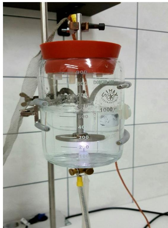
**Slika 5.** Reaktor s tekućinskim izvorom plazme (vlastita slika)
