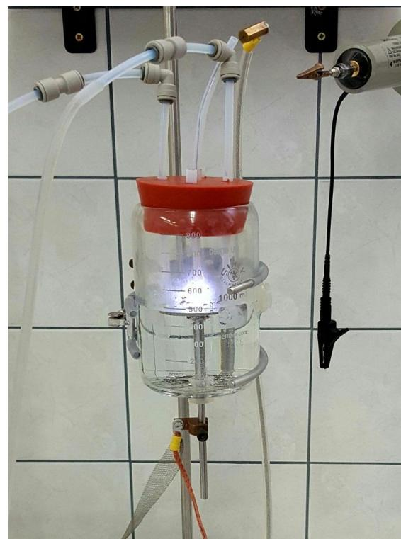
**Slika 6.** Reaktor s plinskim izvorom plazme (vlastita slika)
