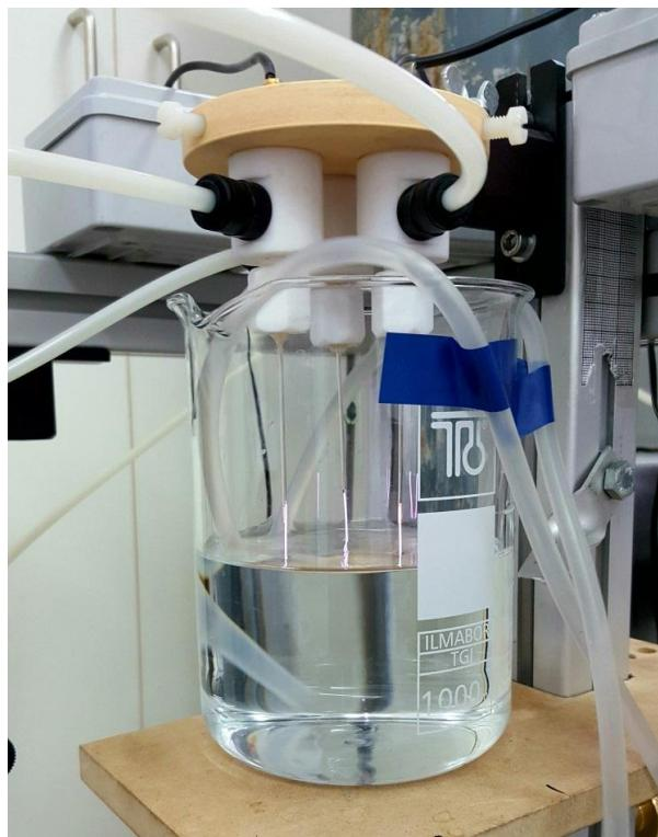
**Slika 8.** Reaktor s JET izvorom plazme (vlastita slika)
