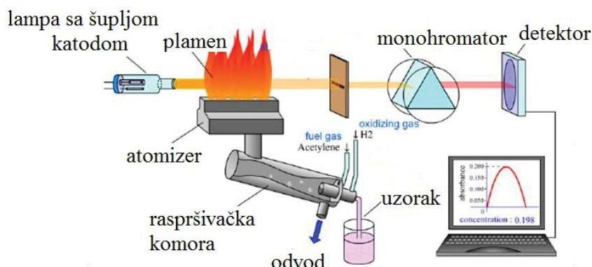
Slika 4.: Princip rada apsorpcijskog spektrometra (Anonymous 4)
