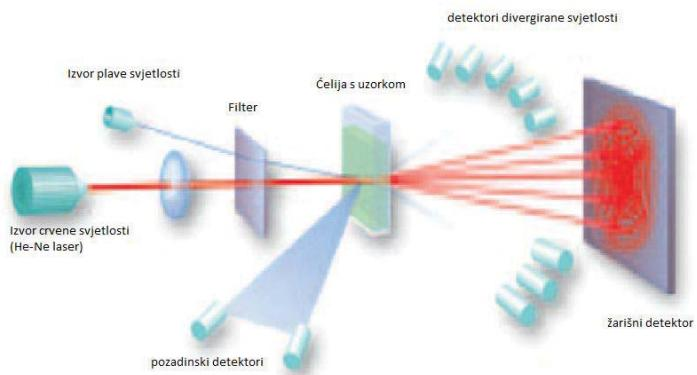
Slika 3.: Princip rada laserskog analizatora (Anonymous 3)
