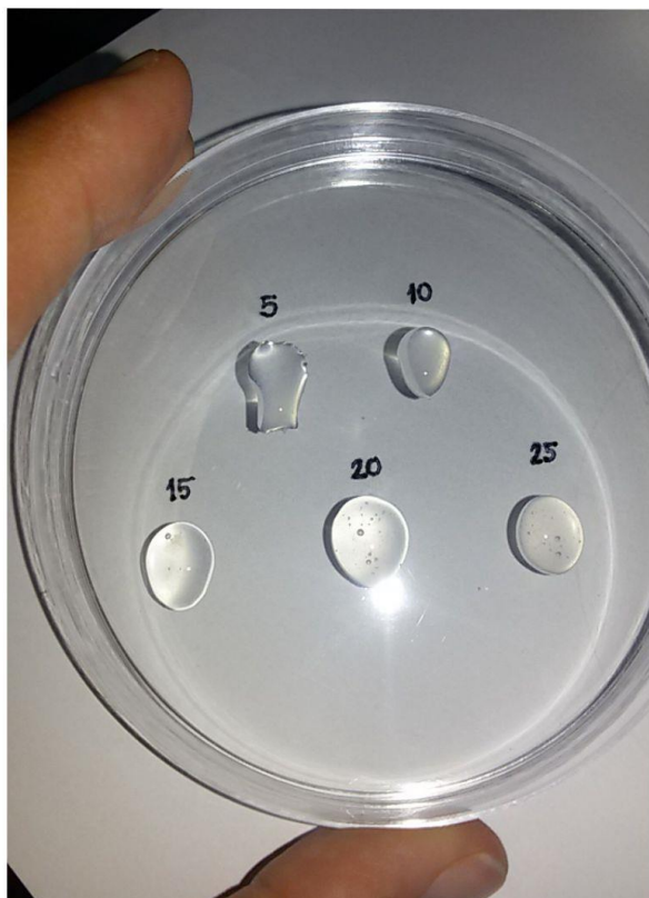
Slika 6. Određivanje optimalne koncentracije guar brašna
