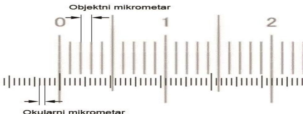
**Slika 6.**Objektni i okularni mikrometar (Anonymus 6, 2012)
