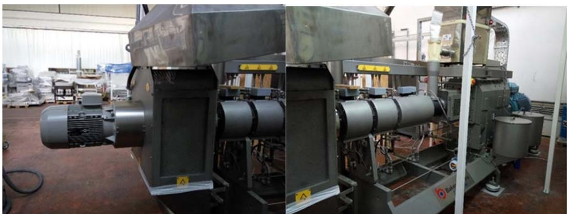
Slika 4. Dvopužni ekstruder (Baker Perkins twin extruder) (vlastita slika)
