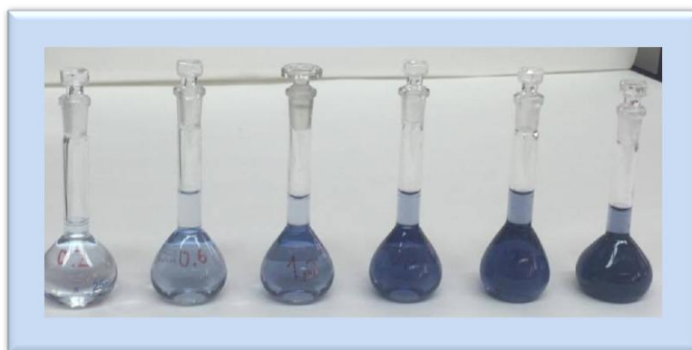
Slika 6. Standardne otopine pripravljene za spektrofotometrijsko određivanje ukupnih fenola (osobna fotografija).
