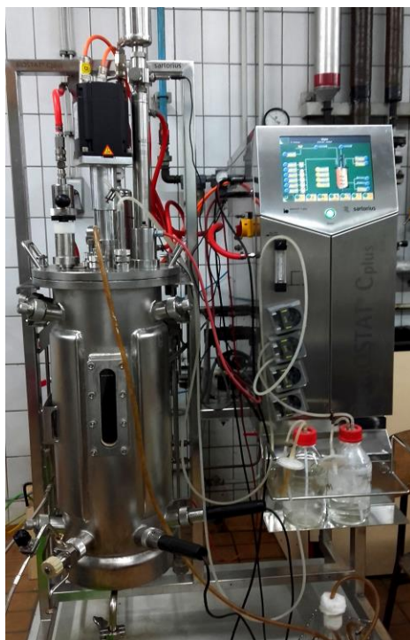
Slika 3. Laboratorijski bioreaktor s miješalom i mjerno-kontrolnom digitalnom jedinicom Biostat Cplus (Sartorius BBI Systems GmbH, Goettingen, Germany).
