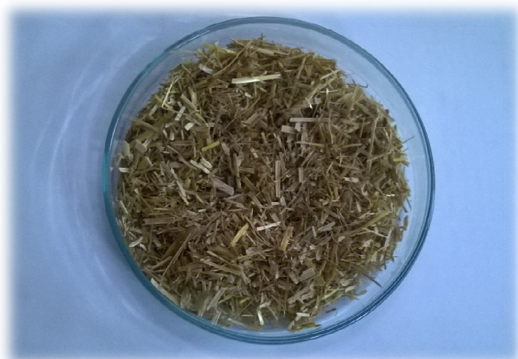
Slika 6. Pšenična slama usitnjena mlinom čekičarom.
