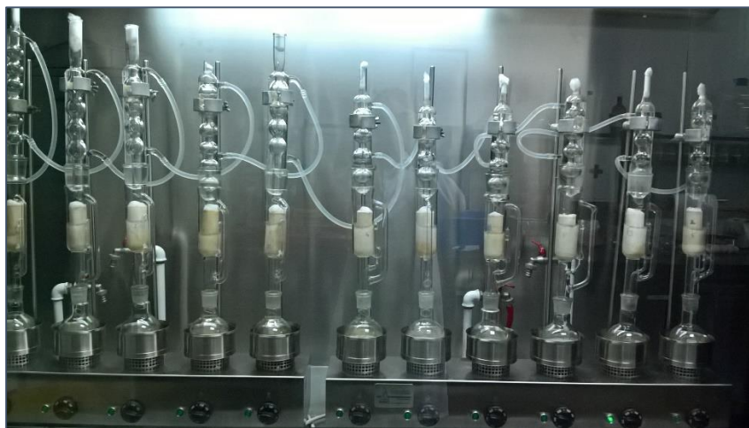
Slika 8. Aparatura po Soxhletu (vlastita fotografija)
