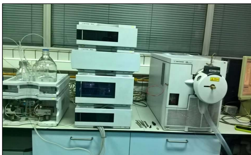
Slika 10. HPLC sustav (vlastita fotografija)
