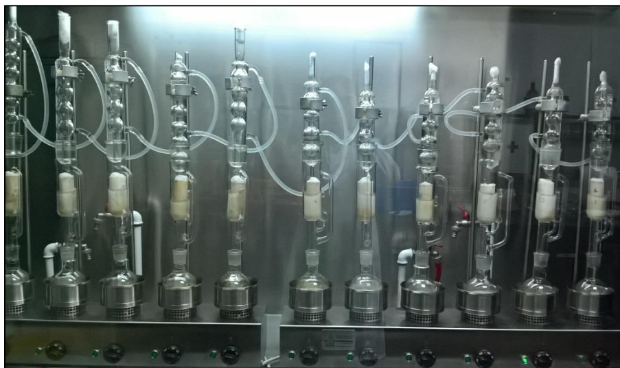
Slika 6. Aparatura po Soxhletu (vlastita fotografija)
