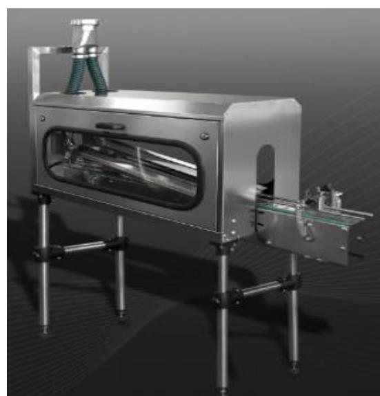
Slika 25. Stroj za sušenje boca (Šraml, 2016m)
