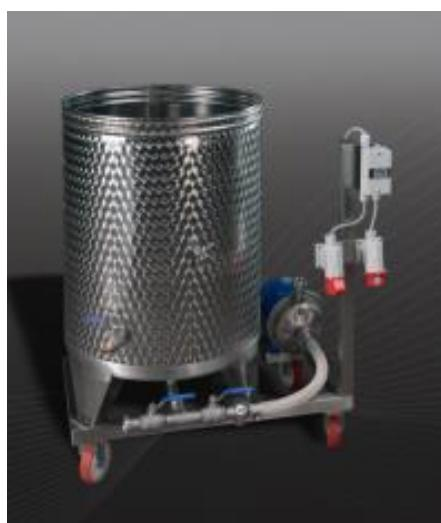
Slika 22. Otvoreni tank za pranje uređaja i opreme (Šraml, 2016j)
