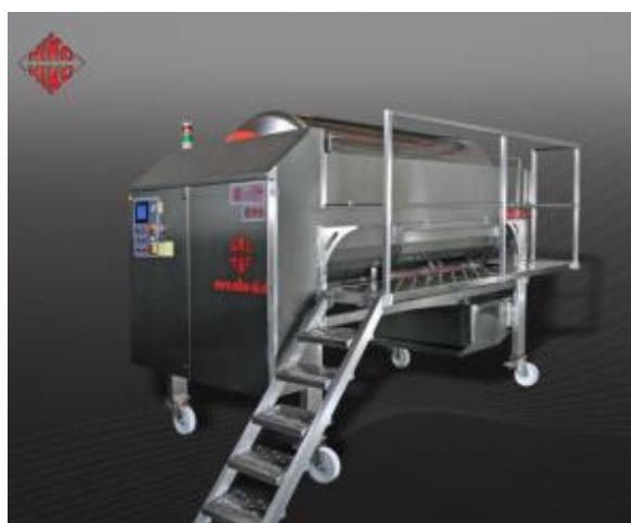
Slika 17. Pneumatska preša (Šraml, 2016f)
