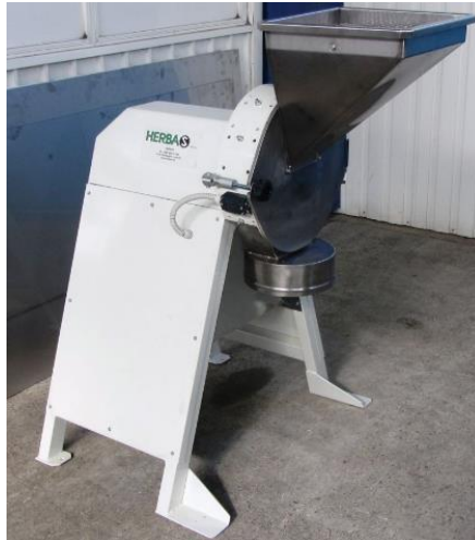
Slika 28. Rezačica za usitnjavanje biljne mase (Herbas, 2017)
