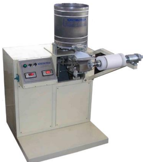
Slika 29. Stroj za pakiranje čaja u filter vrećice (Pak-Projekt, 2017)
