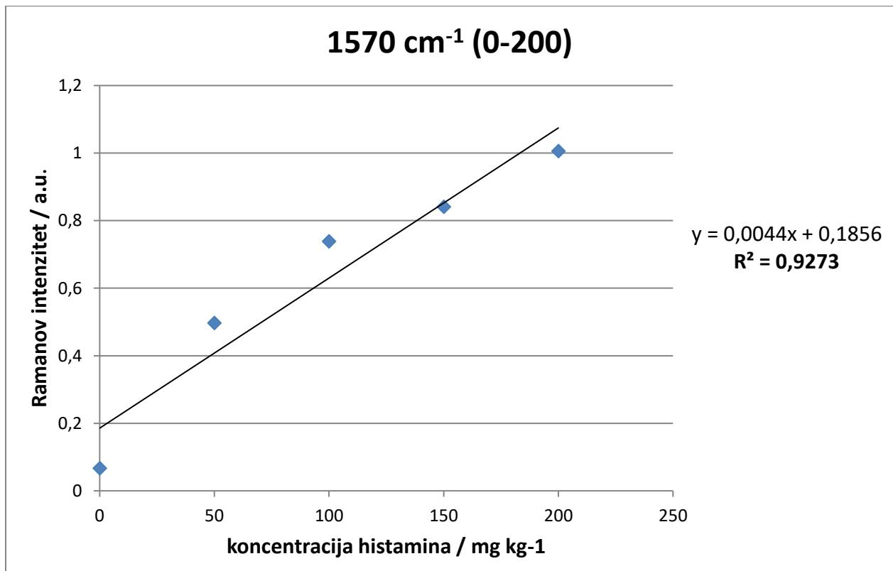
Slika 13. Ovisnost Ramanovog intenziteta o koncentraciji histamina a) na 1264 cm<sup>-1</sup>; b) na 1570 cm<sup>-1</sup>
