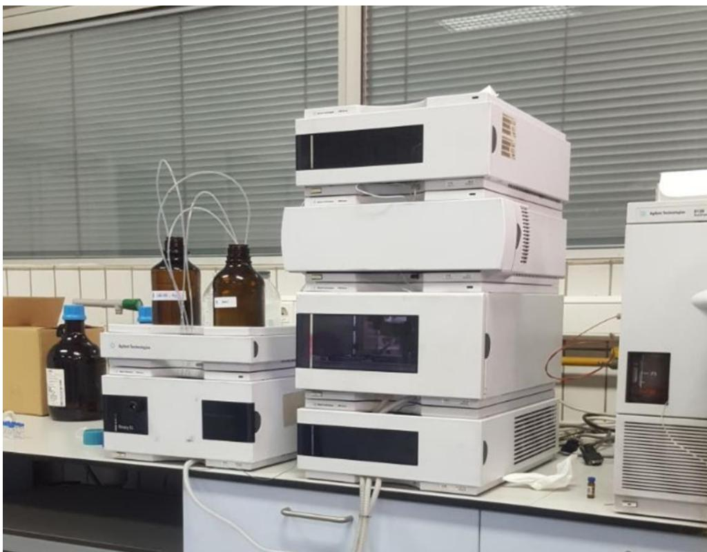
Slika 8. Tekućinski kromatograf Agilent 1200 series HPLC, Laboratorij za tehnologiju mesa i ribe
