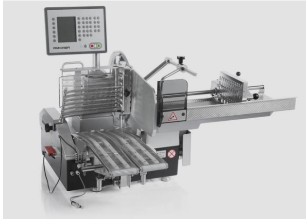
Slika 15. Stroj za narezivanje u nareske (Bizerba, 2017)
