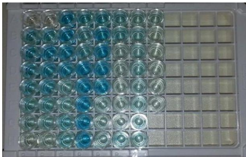
Slika 8. Ploča s uzorcima nakon dodanog supstrat/kromogena i razvoja boje
