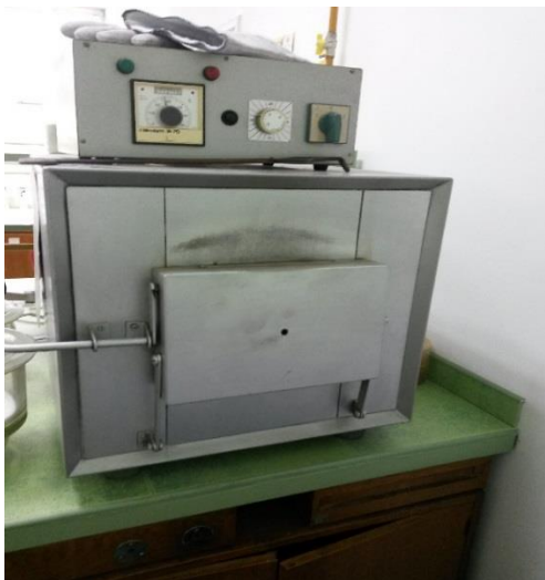
Slika 8. Mufolna peč za žarenje, Iskraterm, tip IP-08 (vlastita fotografija)
