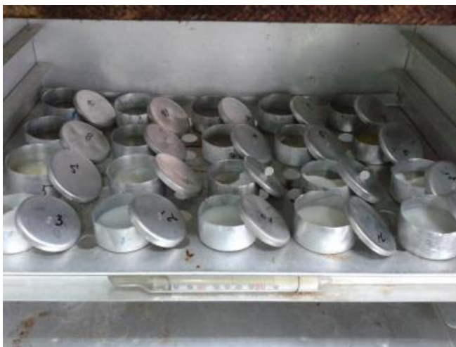
Slika 7. Određivanje udjela suhe tvari u sušioniku, Instrumentaria Zagreb, ST-01/02 (vlastita fotografija)
