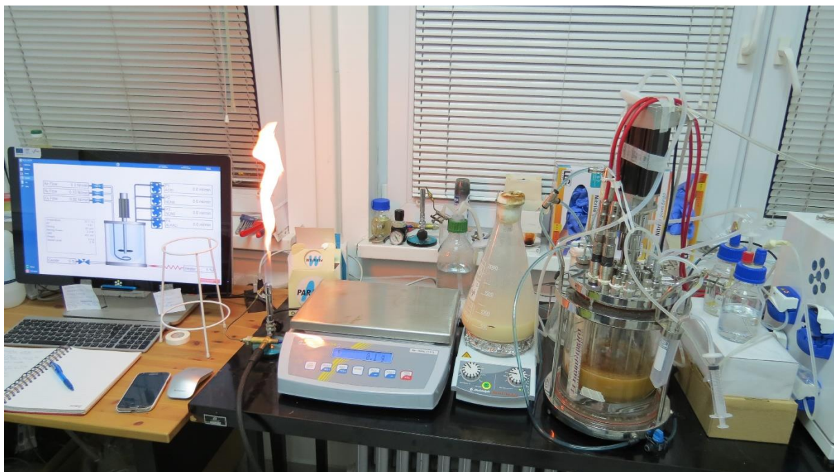
Slika 10. Prikaz in vitro sustava prilikom uvođenja prihrane u sterilnim uvjetima.
