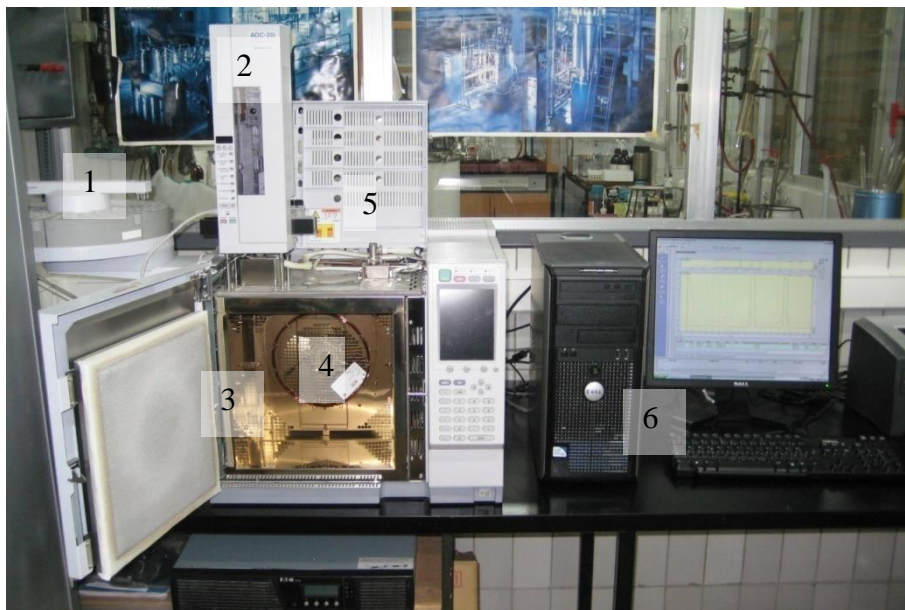
Slika 3.1. Plinski kromatograf Shimadzu GC-2010 Plus AF (Shimadzu, Kyoto, Japan). 1. automatski uzorkivač; 2. automatski injektor; 3. peć; 4. kapilarna kolona; 5. plameno-ionizacijski detektor; 6. računalo s programom za prikupljanje i obradu podataka.
