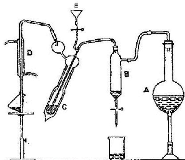
**A** – okrugla tirkvica (služi za razvijanje vodene pare)
