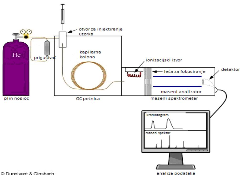
Slika 5. Shematski prikaz rada GC-MS uređaja (Anonymous 3)
