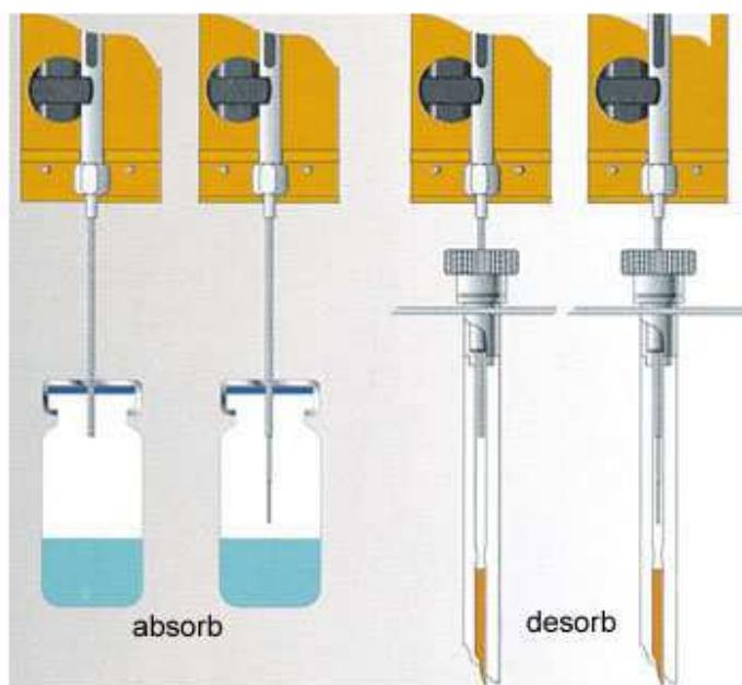
Slika 4. Postupak absorpcije na vlakno i desorbcije na analitički instrument (Anonymous 2)
