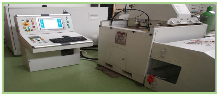
Slika 12* . Uređaj za visoki hidrostatski tlak (Stansted Fluid Power, Velika Britanija).
