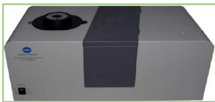
Slika 15* . Kolorimetar CM-3500d (Konica-Minolta, Japan).
