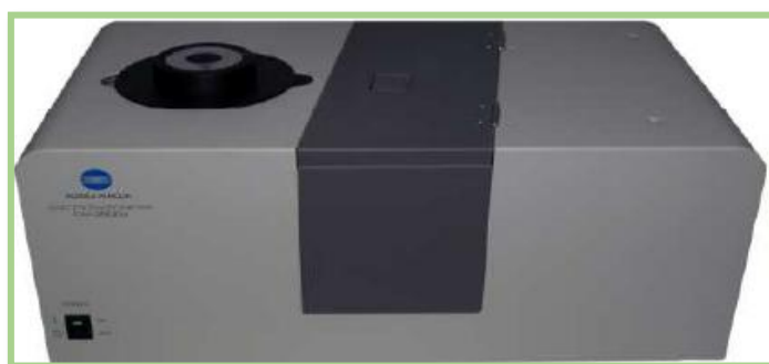
Slika 15* . Kolorimetar CM-3500d (Konica-Minolta, Japan).
