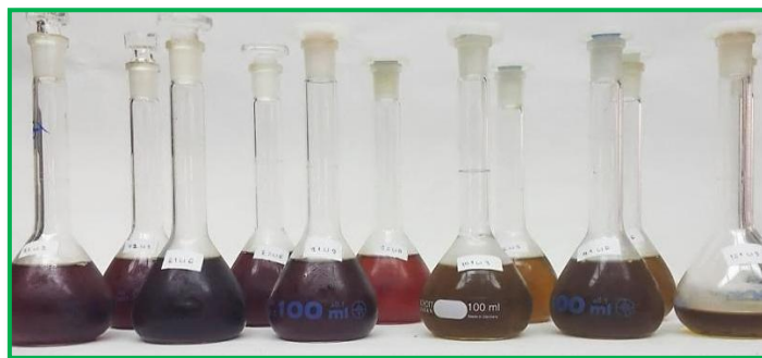
Slika 13* . Ekstrakti lišća ružmarina dobiveni ekstrakcijom potpomognutom visokim tlakom.
