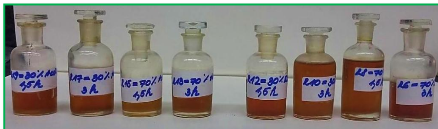
Slika 14* . Ekstrakti lišća ružmarina dobiveni ekstrakcijom refluksiranjem.
