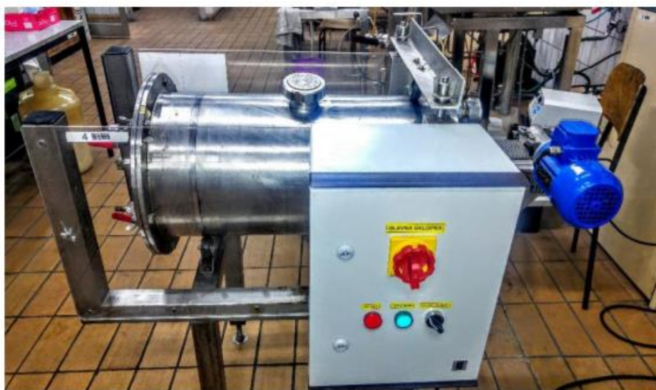
Slika 8. Horizontalni rotirajući cijevni bioreaktor (Rosing d.o.o., Hrvatska).
