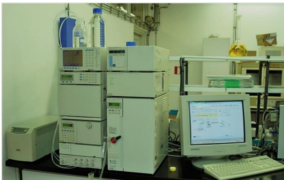
Slika 7. HPLC- Shimadzu CLASS-VP LC-10A VP sustav (Japan).
