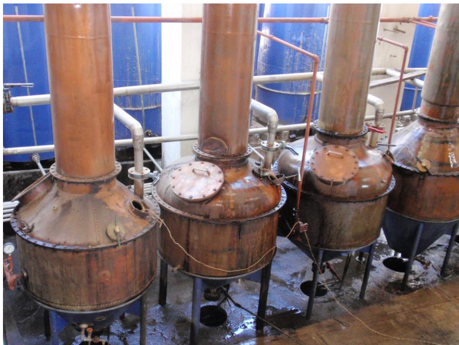
Slika 19. Bakreni kotlovi za destilaciju
