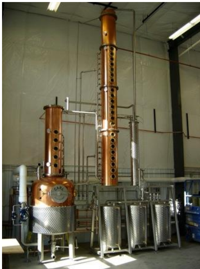
Slika 20. Kontinuirana destilacija u kolonama
