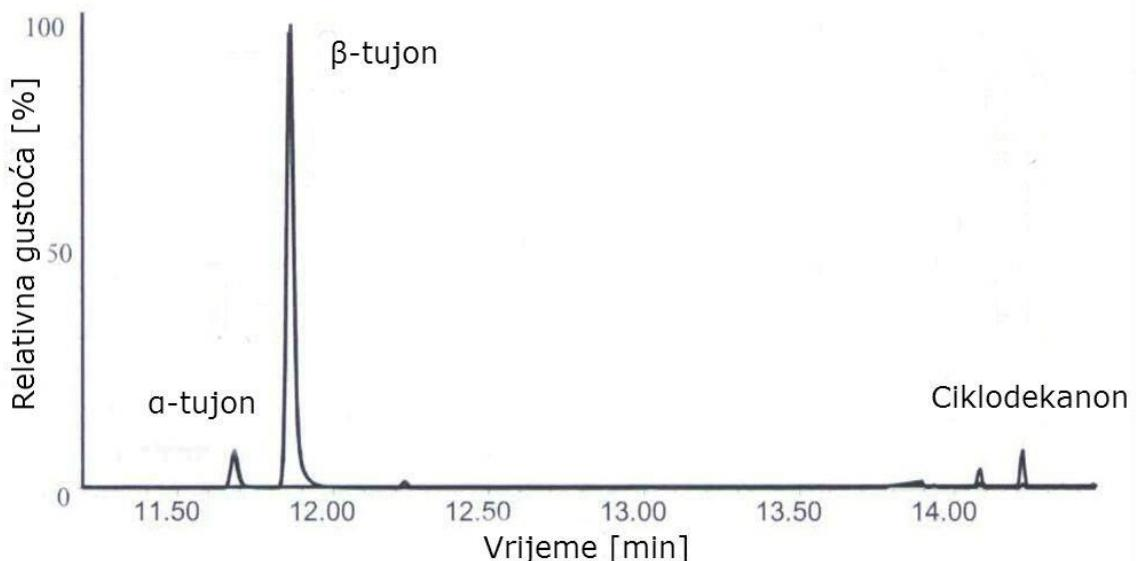
Slika 9. Karakteristični HS-SPME/GC/MS-SIM kromatogram autentičnog apsinta (55% vol.)
