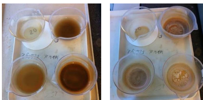
Slika 18. Prikaz uzoraka (3,4,5,6) u vatrostalnoj posudici prije sušenja (lijevo) i nakon sušenja i spaljivanja (desno)
