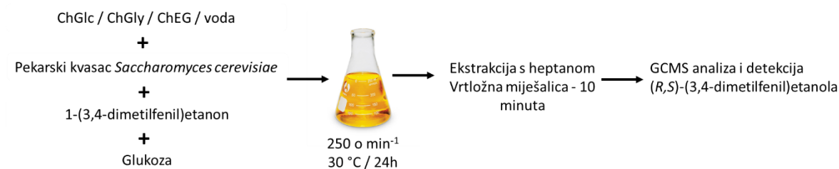
Slika 8. Pojednostavljena shema redukcije 1-(3,4-dimetilfenil)etanona i detekcije produkta
