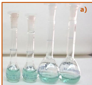
Slika 5. Otopine espresso kave (a) i otpada dobivenog njenim konzumiranjem (b) pripremljene za određivanje ukupnih proteina UV/Vis spektrofotometrijom.
