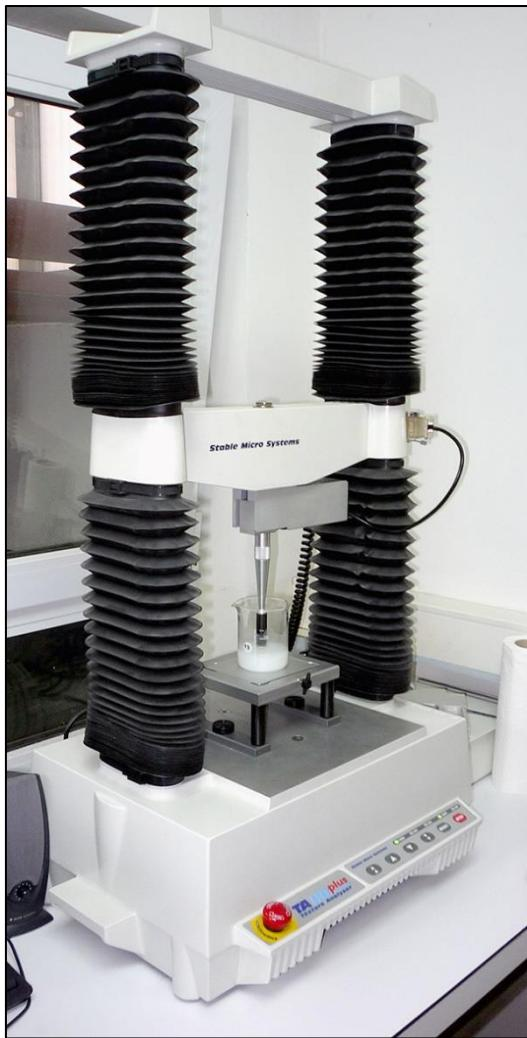
**Slika 8.** Texture Analyzer HDplus (vlastita fotografija)
