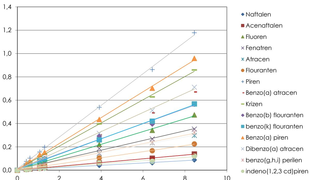
**Slika 50.** Linearnost kalibracijskih pravca policikličkih aromatskih ugljikovodika koncentracije 0,25-20  $\mu\text{g}/\text{kg}$
