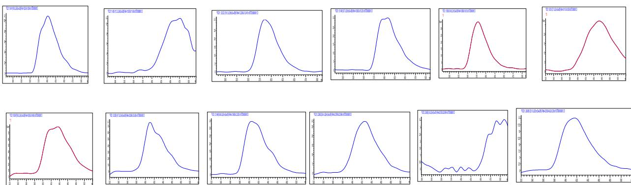
**Slika 49.** Snimljeni spektri pojedinačnog analita za potvrđivanje prisustva spektralnom analizom (navedeni redoslijedom kojim se pojavljuju): fenatren, atracen, flouranten, piren, benzo(a)piren, krizen, benz (b) fluoraanten, benz (k) fluoranten, benz (a) piren, dibenzo (a) atracen, benzo (g,h,i) perilen i indeno (1,2,3 cd) piren
