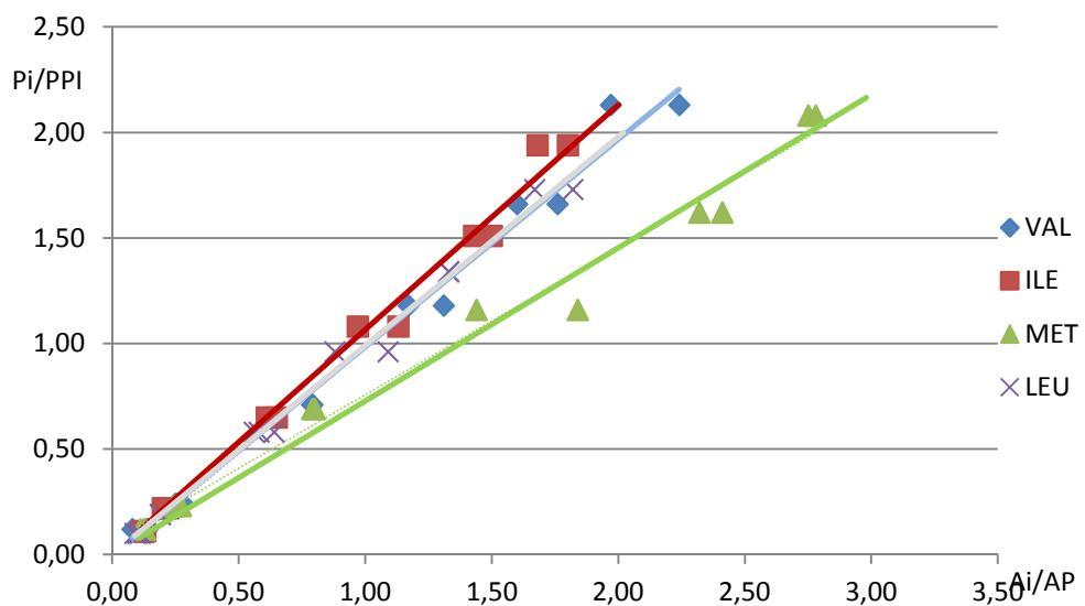
Slika 43. Kalibracijska krivulja s šest koncentracijskih nivoa: valin, izoleucin, metioni i leucin
