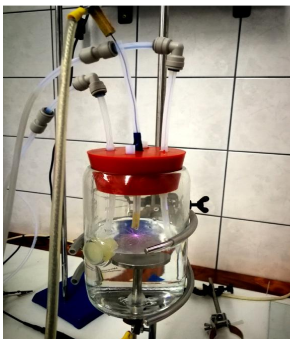
Slika 4. Tretman destilirane vode plazmom generiranom u plinskoj fazi (vlastita slika)
