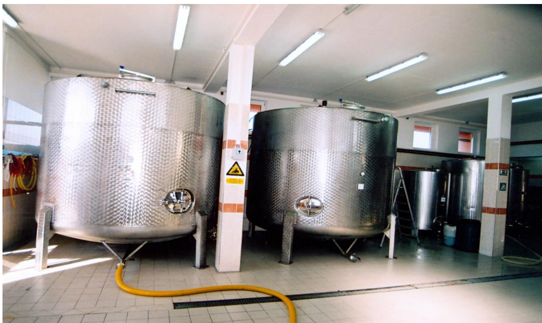
Slika 3. Tankovi u kojoj se fermentira komina jabuke
