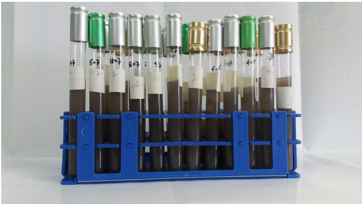
Slika 6. Sulfitni agar koji se koristi za određivanje prisutnosti sulfito-reducirajućih klostridija
