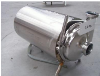
Slika 6 – Centrifugalna pumpa (GEA, 2016)
